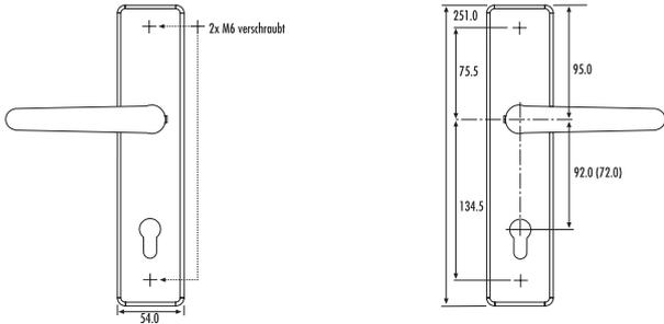
Aluminium-Clip-Deckschilder auf Druckguss-Unterkonstruktionen mit Kugelrasten
